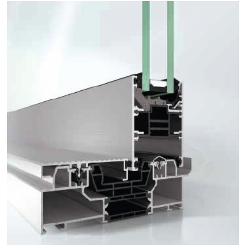
Blendrahmen mit anextrudierten Rinnenprofilen reduzieren Fertigungsschritte und Artikelanzahl Outer frames with co-extruded gutter profiles reduce the number of fabrication steps and articles
